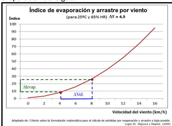
**Figura 8.** Efecto de la velocidad del viento sobre los valores de la constante (Cte.).
