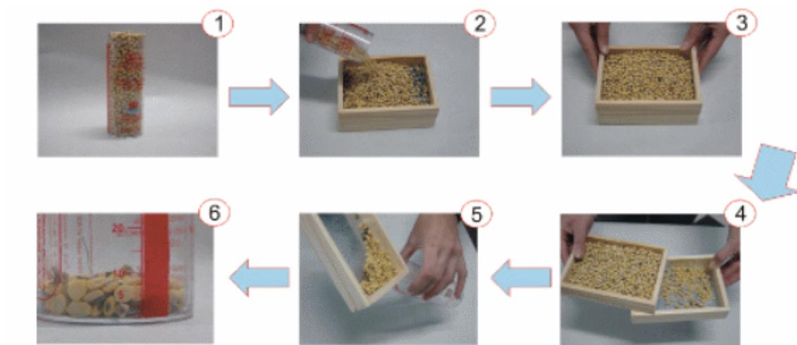
**Figura 2.** Pasos para la utilización de la zaranda evaluadora utilizada para separar grano de Soja partido. Fuente: INTA PRECOP, 2006.
