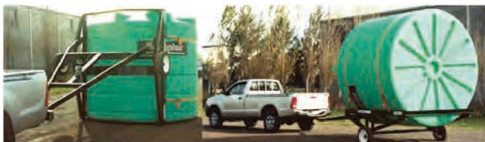
Figura 6. Trailer utilizados para el transporte de tanques rotomoldeados (imagen gentileza, Máximo Uranga)
