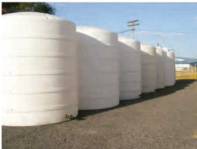
Figura 5. Tanques rotomoldeados utilizados para el almacenamiento de fertilizantes líquidos en plantas de distribución minorista y a campo.
