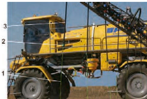
Figura 13. Pulverizadora adaptada para fertilizante. 1) chorro de fertilizante; 2) pico con pastilla de chorro; 3) tubo de bajada.
