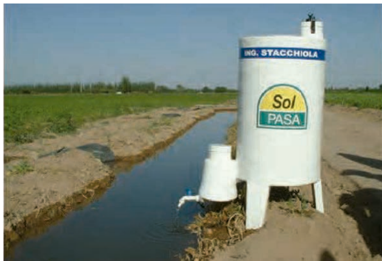
Figura 11. Dosificador de fertilizante líquido para fertirriego en surcos (imagen gentileza Jorge Bassi).
