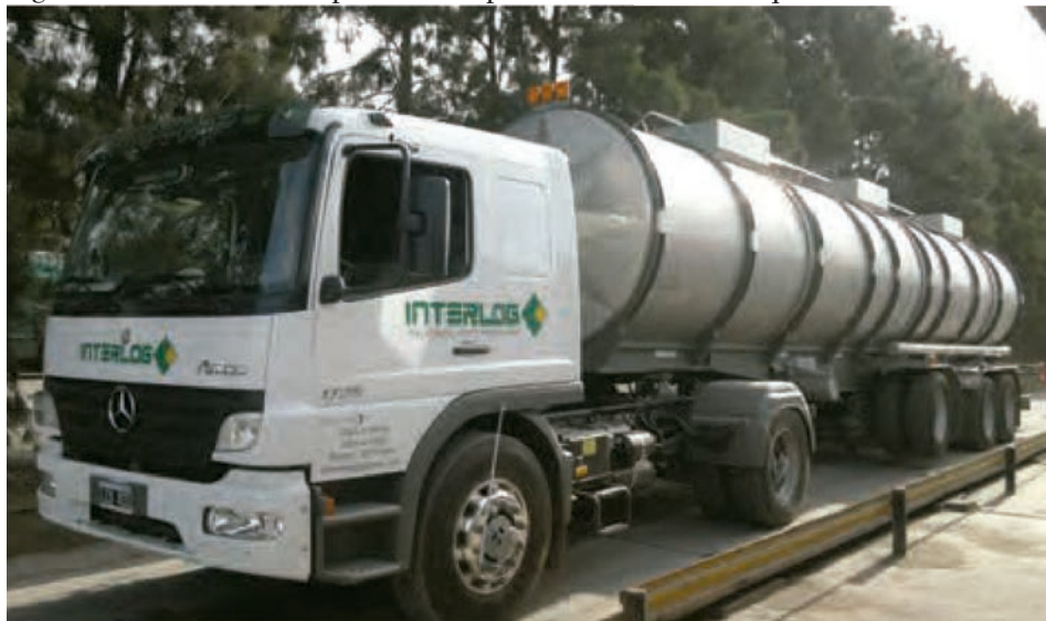
Figura 4. Camión cisterna para el transporte de fertilizantes líquidos
